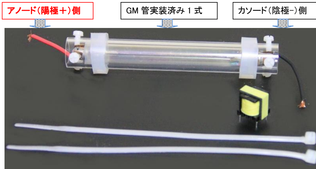
結束バンドで GM 管実装済み 1 式を固定後の様子
